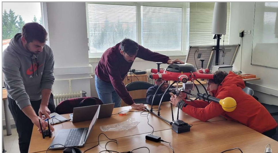
Εικόνα 9: Στήριξη του SRM-3006 στο drone
