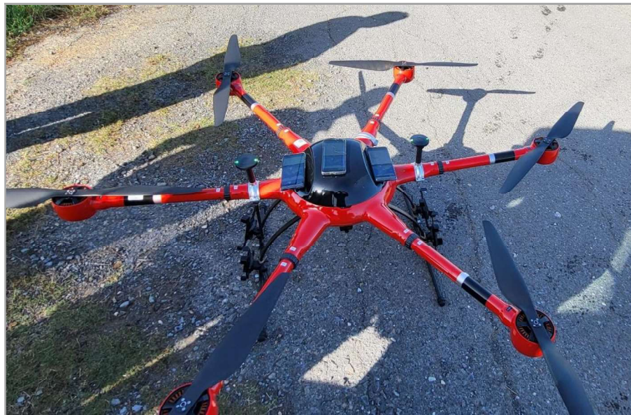
Εικόνα 11: Στήριξη των Echo One μετρητικών κινητών στο drone
