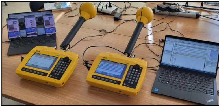
Εικόνα 7: Εργαστηριακό τεστ δύο SRM3006 σε συνδυασμό με την λειτουργία τριών τερματικών κινητής που είναι συνδεδεμένα σε 2G, 4G και 5G.
