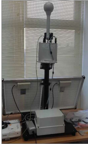
Εικόνα 1: Σταθερός μετρητής ΗΜ ακτινοβολίας 24ώρου (AMS806i)
