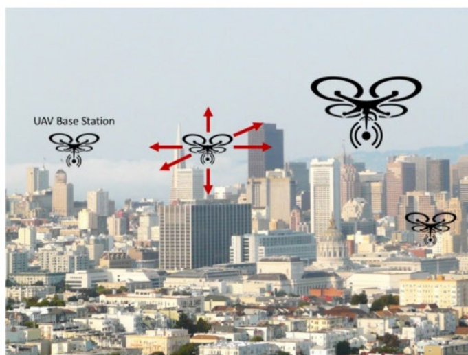
Εικόνα 1. Χρήση των UAVs ως ενάεριοι σταθμοί βάσης σε αστική περιοχή [2]
